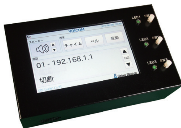
タッチパネル IF、接点 IF、音声 IF を実装したカスタマイズ例
