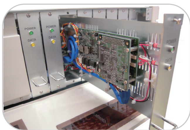
接点 IF、音声 IF をラック実装したカスタマイズ例
